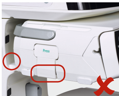
Figure 6: Prawidłowo (góra) i nieprawidłowo (dół) zainstalowana pompa.
